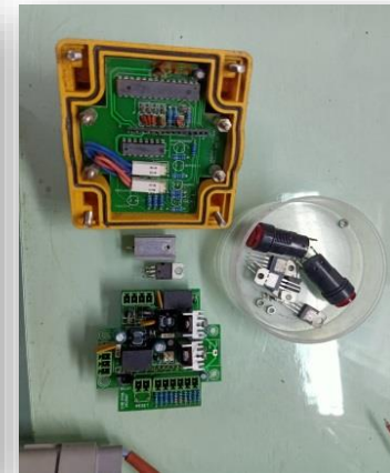
bord power supply ที่ทำการซ่อม
